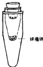
图 1 三个 Eppendorf 管套接示意图
